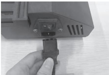
5. 电源线插入打印机左侧电源开关下方电源连接接口。
