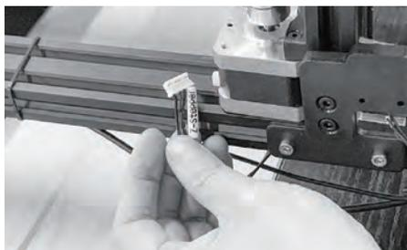
19. 在打印机左右两侧找到标有[Z-Stepper]字样的[Z轴电机线]。将他们分别插入左右两侧的Z轴电机。注意，在插入电机线时，插头上有两条突起的一面应当朝上。
