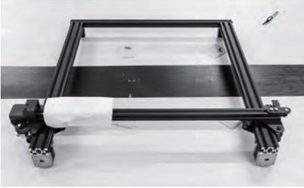
1. 如图所示，取出打印机上支架放于桌面，去除保护泡棉。
