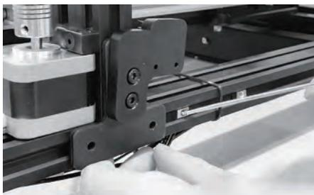
11. 如图所示，为固定两侧的T型固定座，在左右两侧滑槽内找到T型螺母（左右各两颗）。将其调整到T型紧固件的两个螺丝孔位。
