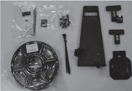
9. 检查工具箱中的配件：工具袋、存储卡、螺丝袋、耗材、扎带、丝盘固定座、丝盘轴、Z轴T型固定座、Z轴T型固定座+传感器。
