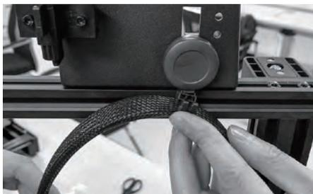
18. 将喷头线束卡入丝盘固定座上滑轮前的卡扣。
