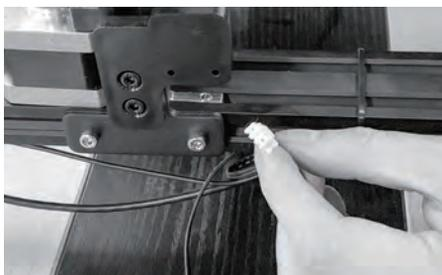
22. 将Z轴传感器线插入Z轴传感器，传感器位于左侧T型固定座内侧。注意，插头上有两条突起的一面应当朝向打印机右侧。
