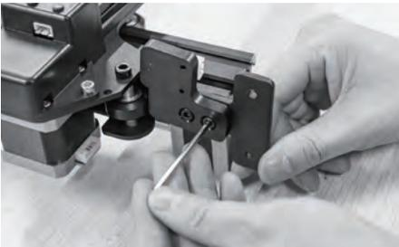
5. 略微旋紧T型固定座上之前旋松的螺丝，请注意，在这一步骤时请不要将这两颗螺丝拧紧。
