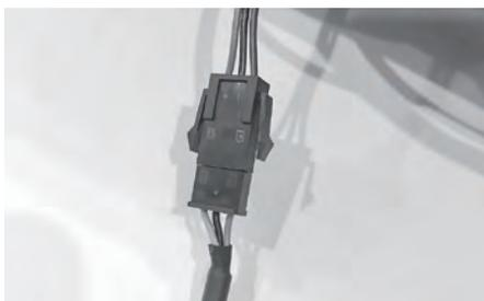
6. 将感应器的插头于打印机液晶屏后部的传感器线相连。
