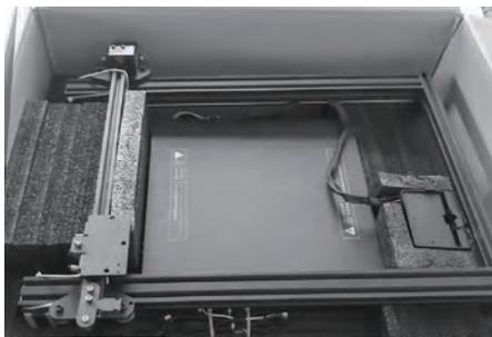
8. 移除左右两侧的泡沫块，取出下方的打印机上支架。
