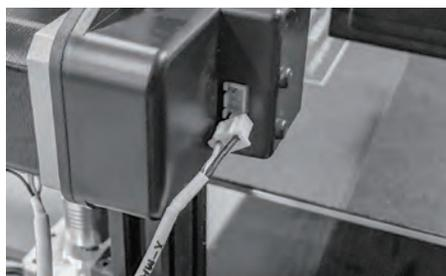
23. 如图所示，找到标有[X-Max]的[X轴传感器线]。将其插入X轴电机背后的X轴传感器插口。注意，插头上带有两条突起的一边朝向打印机后方。
