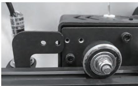
5. 将固定座放置于喷头右侧，用两颗螺丝固定。
