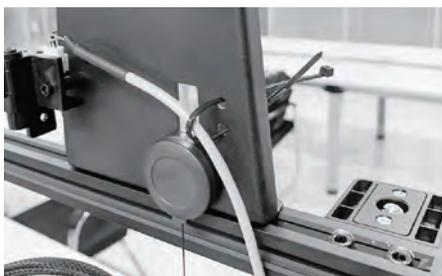
26. 如图所示，用扎带固定[丝料检测传感器线]。硬件安装完成。
