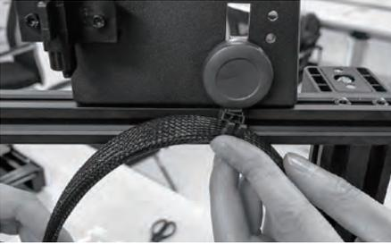
7. 由于感应器线过长，请将感应器线卡入顶部丝盘固定座上的滑轮卡扣中。
