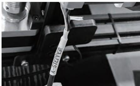
20. 在打印机左侧找到标有[X-Stepper]字样的[X轴电机线]。将其插入X轴电机。注意，X轴电机线的插口在电机下方。在插入电机线时，插头上有两条突起的一面应当朝向打印机正面。
