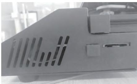
1. 将存储卡插入设备卡槽内。
