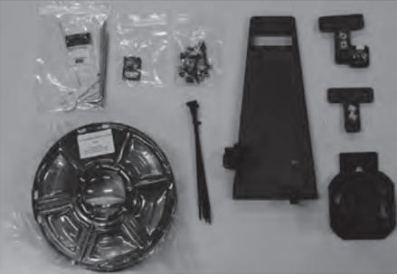
3. 检查工具箱中的配件：工具袋、存储卡、螺丝袋、耗材、扎带、丝盘固定座、丝盘轴、Z轴T型固定座、Z轴T型固定座+传感器。
