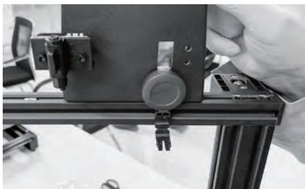
16. 取出丝盘固定座，准备安装在上支架顶部。请注意，安装料盘架时请确保装有丝料检测开关的一侧朝向打印机正面。
